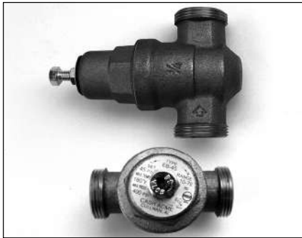
Figure 3 - Installer un détendeur de pression réglé de 50 à 60 PSI.
